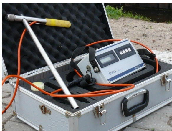
Figuur 3 SENSE RC2 stroomsnelheidsmeter
